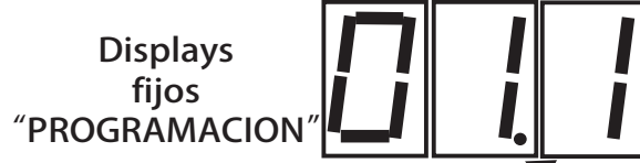
Punto destellando: indica que está en modo programación
